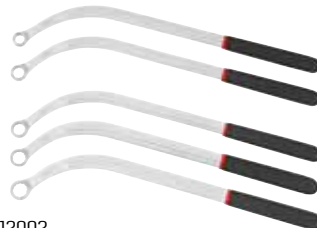
#812002 Spanrolsleutelset gebogen, 5-dlg. - Extra lange uitvoering, 470mm met 12-kant profiel - Sleutelmaten 13 - 15 - 16 - 17 - 19 mm - 45° gebogen kop voor zeer moeilijk bereikbare plaatsen - Anti slip handgrepen voor veilig gebruik - 470mm
