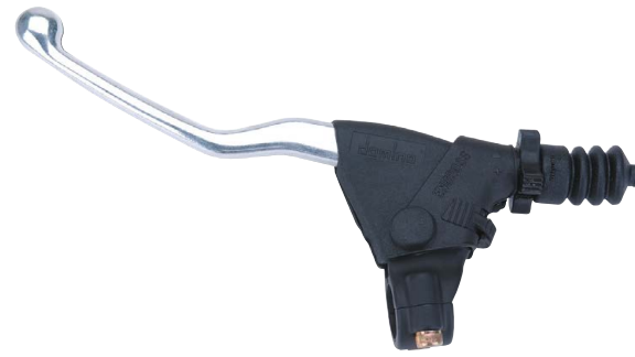
COD. 1467.04 Sinistro - Left fulcro leva - lever fulcrum mm 26 lunghezza leva - lever length mm 178 codice leva - lever cod. 1676.60
