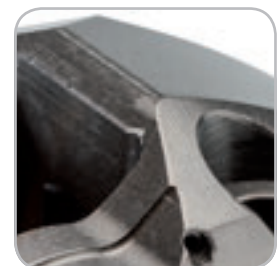
Lavorazione del corpo pinza monoblocco. Monoblock caliper body machining.
