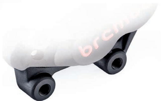
Dettaglio del fissaggio assiale alle forcelle. Detail of axial fitting to the forks.
