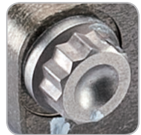
Montaggio a mano e oggettivazione delle coppie di serraggio delle viti. Hand assembly and objectification of screw tightening torques.
